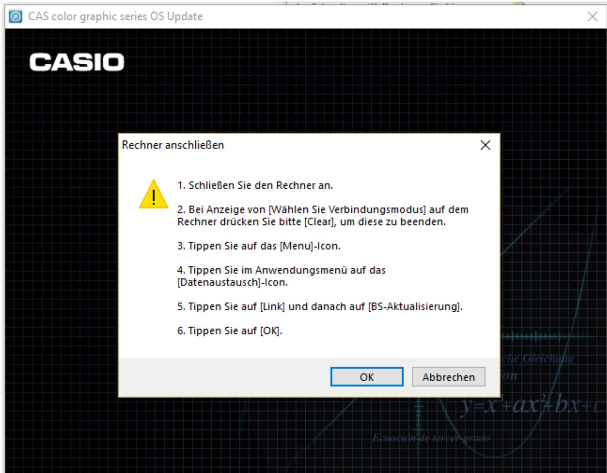
Hinweis: In Schritt 6 zuerst am CAS auf „OK“ tippen, dann das oben abgebildete Fenster mit einem Linksklick auf „OK“ schließen und damit den eigentlichen Update-Prozess starten. Die Aktualisierung dauert einige Minuten.
